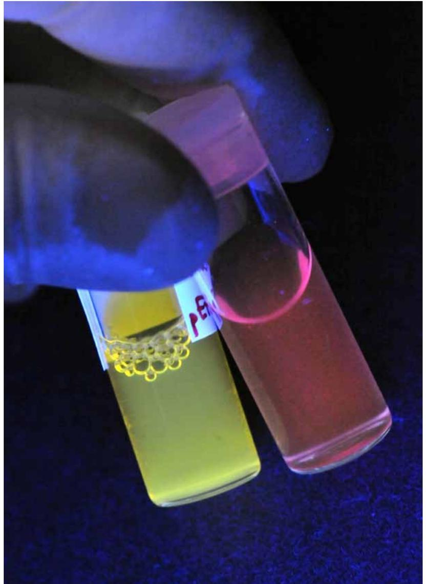
Im Schwarzlicht wird die Leuchtkraft der Nanopartikel sichtbar.
